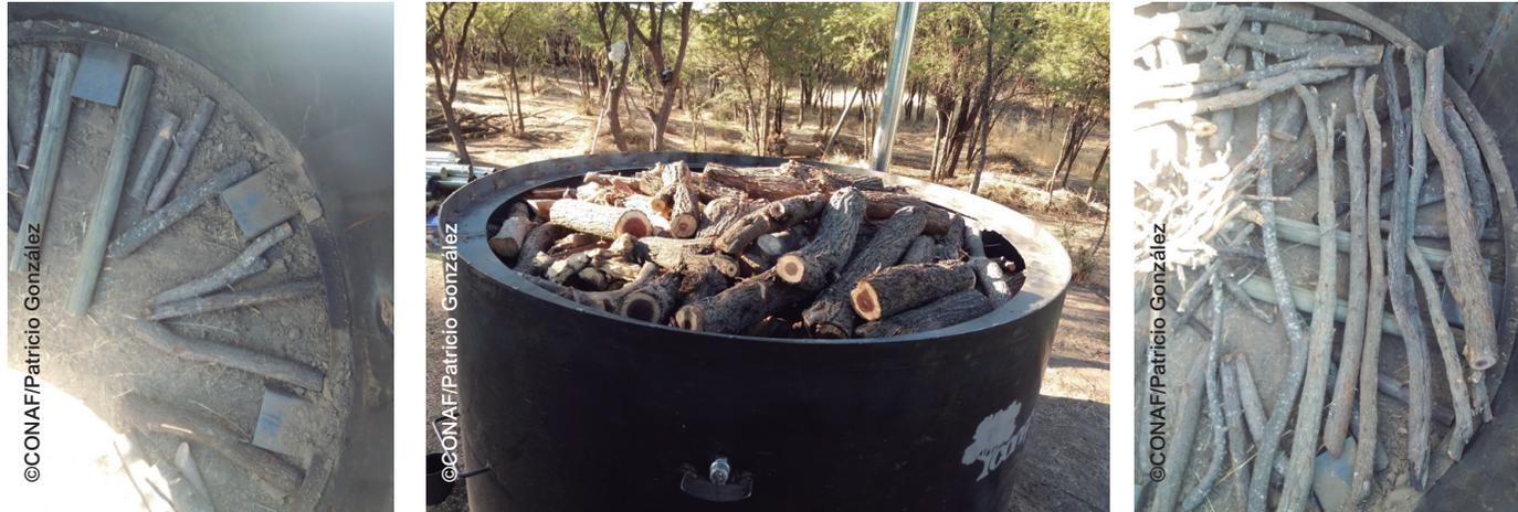
En la etapa de carga de la biomasa, se midió el contenido de humedad de los trozos, siendo requisito utilizar biomasa con un contenido de humedad menor al 25%. Se realizó pesaje de la biomasa a depositar en el horno, con el fin de obtener información de rendimiento.
